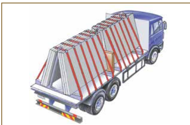
Joonis 63. Paneelid kinnitatakse platvormile kinnitusvahenditega
