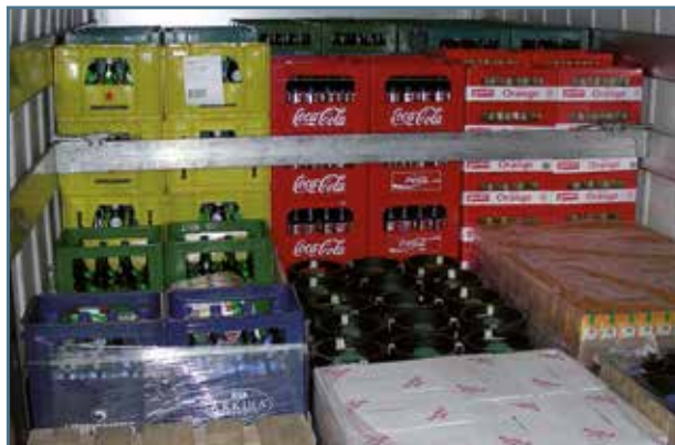
Joonis 13. Tõkestamine vastu esipaneeli ja spetsiaalse vahetalaga
