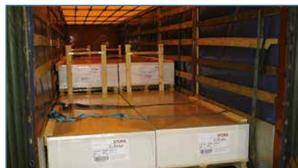
Joonis 19. Paneelblokeering alustel paberipakkidele
