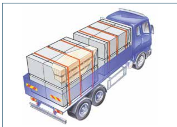
Joonis 51. Saematerjali kinnitatud koorem
