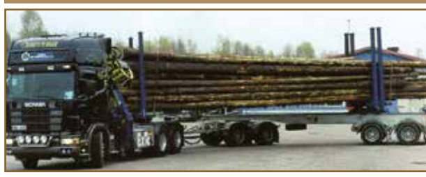
Joonis 70. Pikkade palkide vedu
