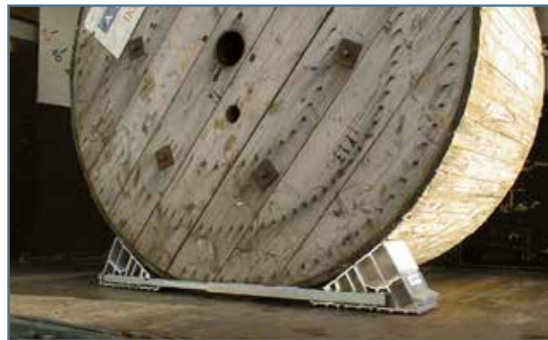
Joonis 21. Tõkestatud kiilud (kiilusäng)
