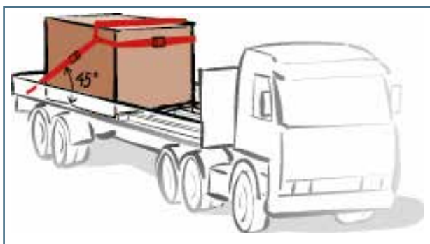
Joonis 26. Diagonaalside ettesuunalise liikumise takistamiseks
