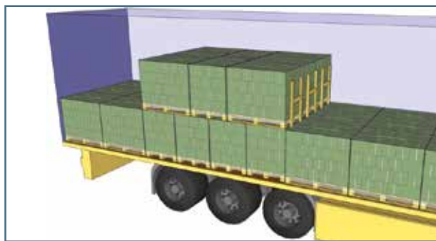
Joonis 18. Paneelblokeering pikisuunalise libisemise tõkestamiseks teises koormakihis
