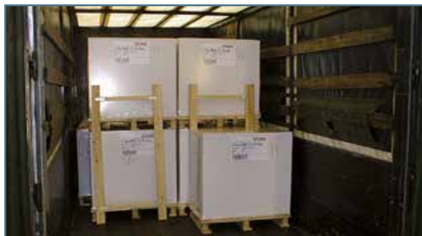
Joonis 18. Paneelblokeering pikisuunalise libisemise tõkestamiseks teises koormakihis
