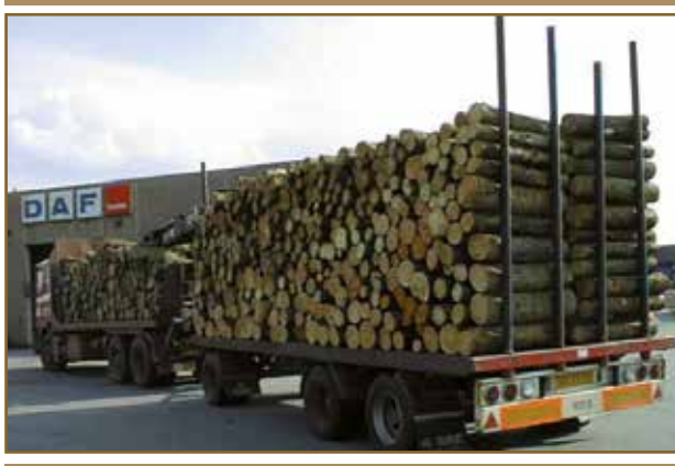
Joonis 69. Ristilaaditud ümarpuitu ei soovitata kasutada
