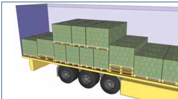
Joonis 17. Lävablokeering pikisuunalise liikumise tõkestamiseks
