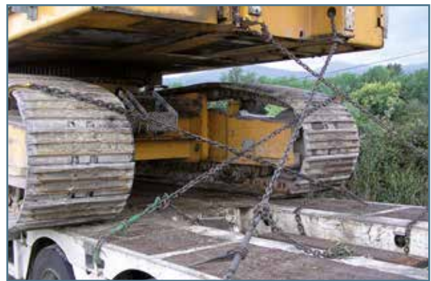
Joonis 39. Diagonaalsete ketsidemetega kinnitatud ekskavaator
