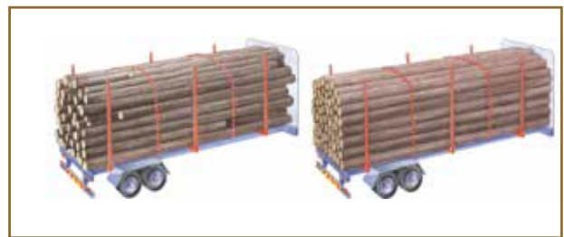
Joonis 66. Ümarpuidu koormakinnitamisel tuleb tugipostidele alati lisada vertikaalsed sidemed
