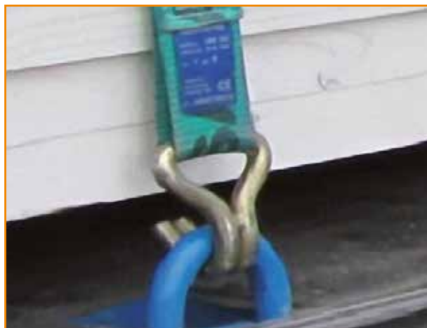
Joonis 8. Sidumisrihmade kinnituskonksud
